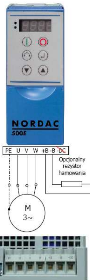
Rys.2 Schemat poglądowy podłączenia silnika do zacisków terminala mocy przemiennika.
